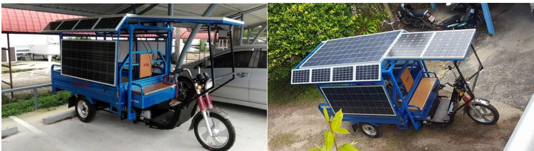
ภาพที่ 4 แสดงภาพติดตั้งแผงโซลาร์เซลล์แล้วเสร็จ
