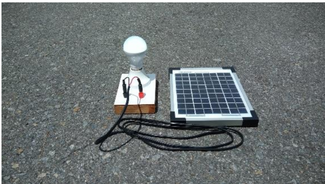
ภาพที่ 11 ฐานการต่อหลอดไฟกับแผงเซลล์แสงอาทิตย์
