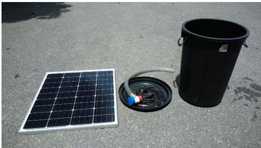
ภาพที่ 13 ฐานการต่อปั้มน้ำกับแผงเซลล์แสงอาทิตย์
